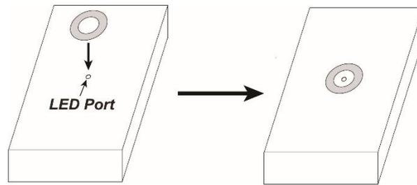
2. Der IR Sensor des Hauptstromzählers hat einen Magnet. Befestigen Sie den Sensor so auf der Unterlegscheibe, dass er freien Zugang zur IR Schnittstelle Ihres Sicherungskastens erhält.
